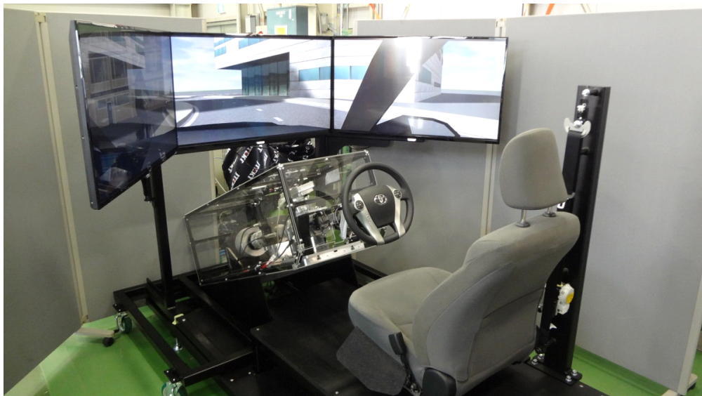
図 34 ミスユース課題を検証するための簡易型ドライビングシミュレータ例（出典：経済産業省委託事業「平成 30 年度 高度な自動走行システムの社会実装に向けた研究開発・実証事業：自動バレーパーキングの実証及び高度な自動走行システムの実現に必要な研究開発（セーフティ）」）
