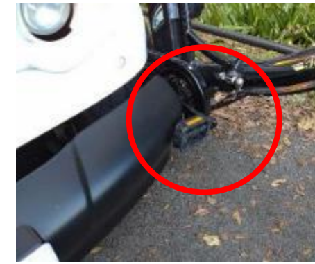
自転車の右ペダルと自動運転車両の接触 状況の再現写真（自転車は同一でない）
