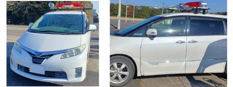
緊急自動車の模擬車両とサイレン音スピーカー・アンプ等
