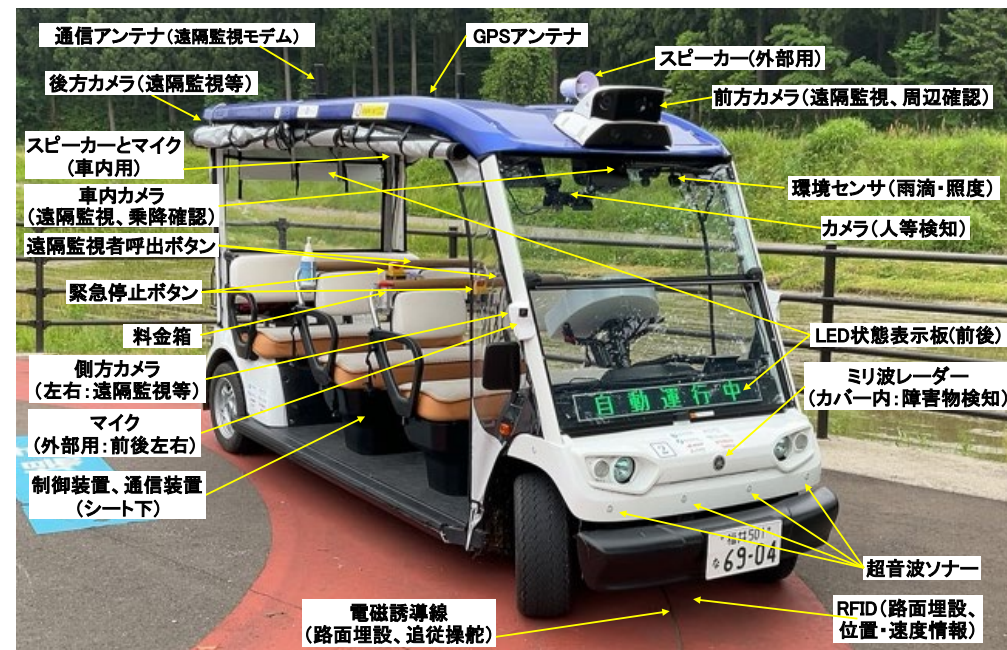
レベル4自動運転移動サービス用車両 (グリーンスローモビリティをベース車)
