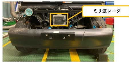
ミリ波レーダ設置位置(バンパー取り外した状態)
