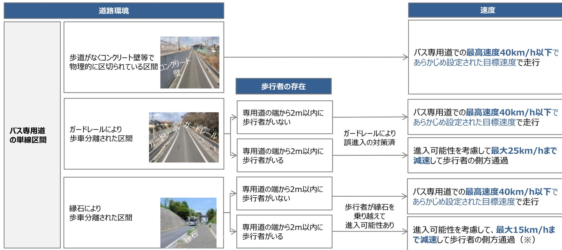
(※) 歩行者が停止した状態から1.5m/s<sup>2</sup>の加速度で進入してきた場合、1.9秒で走行軌道に到達。自動運転バスは15km/hで走行し、飛び出しを検知したら、2.5m/s<sup>2</sup>で減速すれば衝突回避できる。
