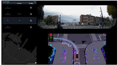
自動運転システム 遠隔管制モニタ
